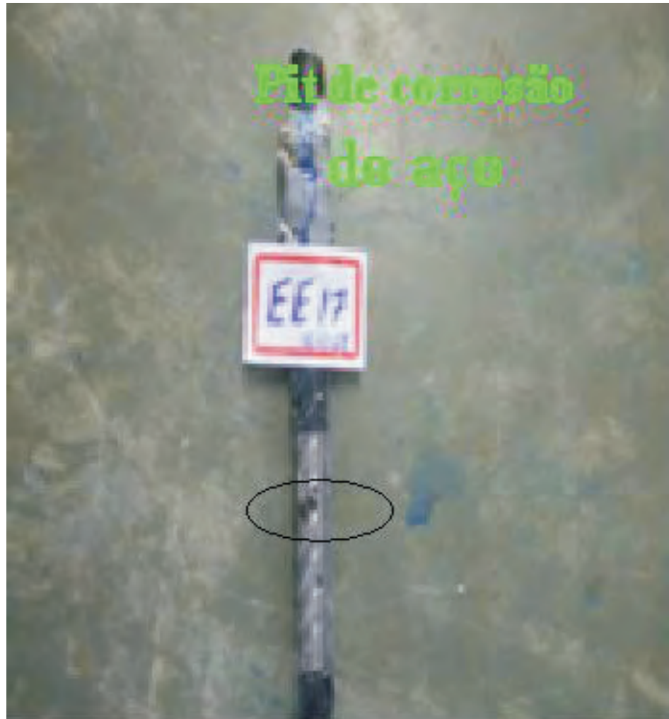
Figura 03- corrosão do aço
