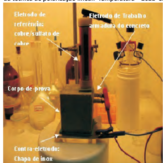
Figura 01 – Montagem experimental para determinação do potencial de despassivação da armadura através da técnica de polarização linear. Temperatura = 26±1°C.
