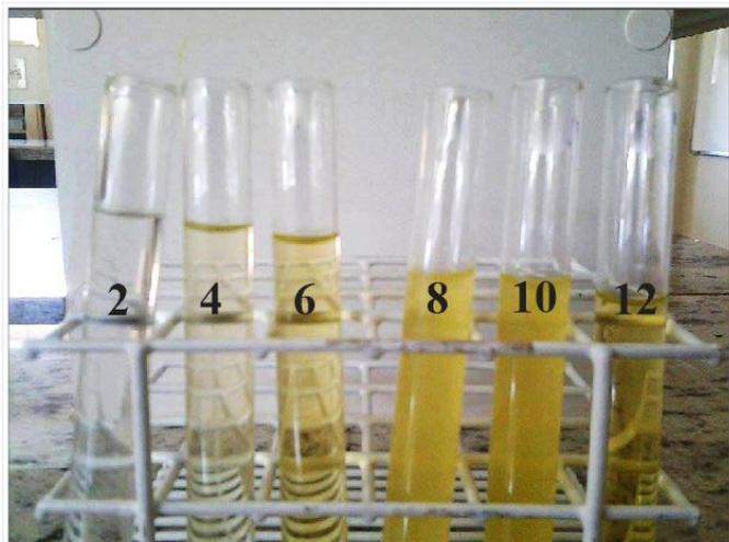
**FIGURA 4.** Soluções aquosas do corante amarelo tartrazina com adsorção em argila branca, em função do pH.
