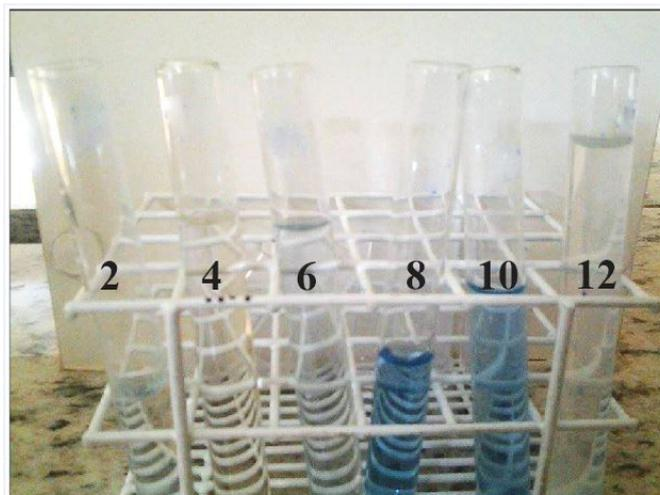
**FIGURA 6.** Soluções aquosas do corante azul indigotina com adsorção por argila branca em função do pH.
