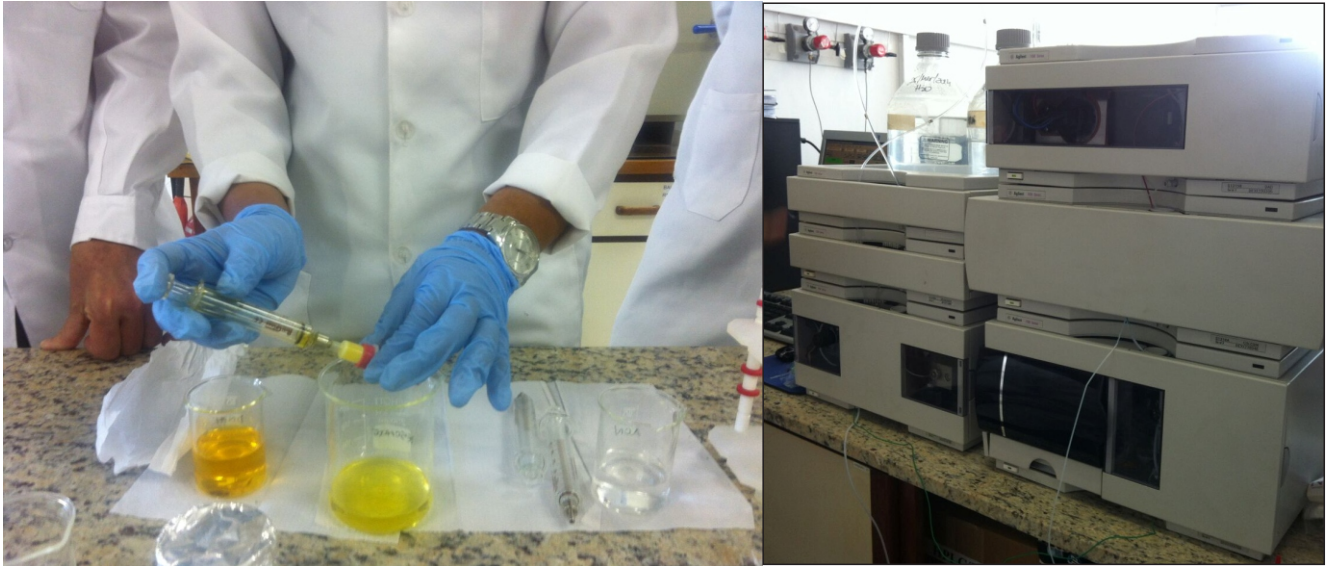
A esquerda a preparação de cartuchos para coleta de compostos carbonílicos presentes no ar. A direita, equipamento usado na determinação de compostos carbonílicos no ar por cromatografia líquida de alta resolução (HPLC)
