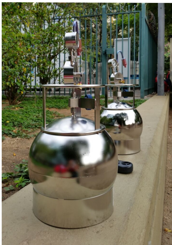
Canister (bujão de aço-inox) para coleta de ar ambiente. Coleta na Praça Saens Peña, na cidade do Rio de Janeiro do lado da Estação de Monitoramento da Qualidade do Ar da Secretaria Municipal de Meio Ambiente
