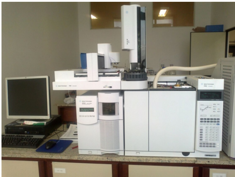
CG-MS-DT Cromatógrafo a gás/detector de massas/dessorção térmica usado na determinação dos compostos orgânicos voláteis
