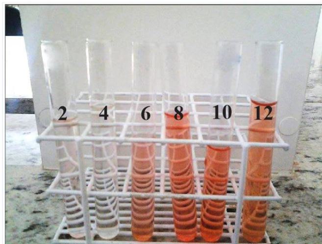
FIGURA 9. Soluções aquosas do corante vermelho-40 com adsorção em pó de telha, em função do pH. Fonte: Arquivo Próprio .
