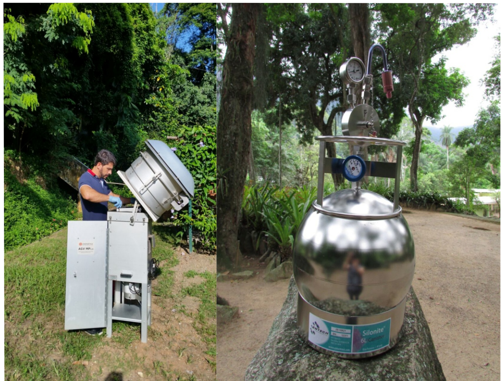
A esquerda: Amostrador de material particulado. A direita: Canister (bujão de aço-inox) para coleta de ar ambiente. Ambos em coleta no Jardim Botânico, no Rio de Janeiro
