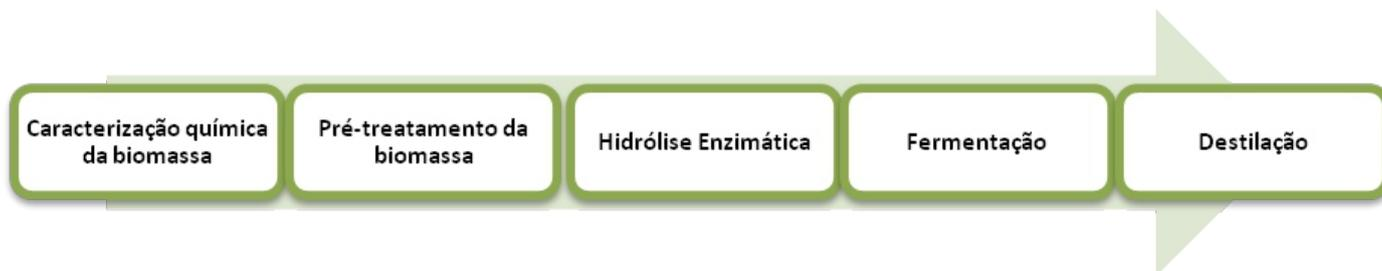
**Figura 1: Principais etapas de produção do etanol de segunda geração, incluindo a caracterização química do material**
