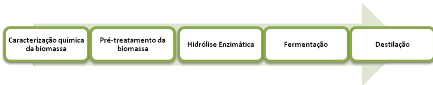
Figura 1: Principais etapas de produção do etanol de segunda geração, incluindo a caracterização química do material
