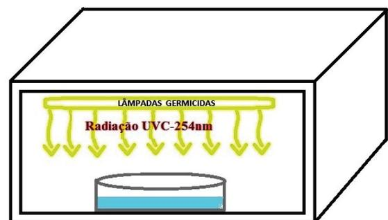
Figura 1 – Representação esquemática do reator fotolítico.
