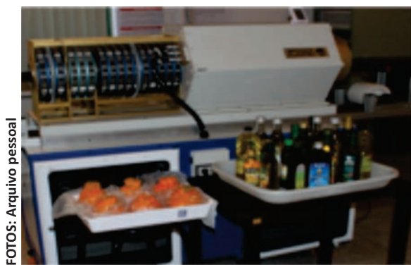
Figura 2. Visão lateral (esquerda) e frontal (direita) do ímã de um aparelho de RMN-DT de 8 MHz, para amostras com diâmetro de até 10 cm usado para análise não invasiva de frutas, alimentos embalados como vinho, azeite de oliva, maioneses, embutidos entre outros alimentos
