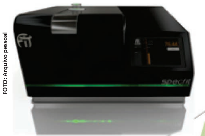
Figura 1. Foto de um espectrômetro de RMN-DT desenvolvido no Brasil e que está sendo usado nas determinações de sementes alto oleico, teor de óleo na indústria de azeite de palma (dendê), teor de gordura sólida em manteiga, margarinas, chocolates entre outras medições
