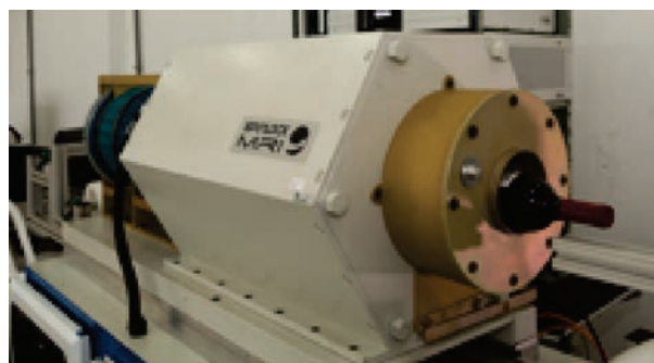
Figura 2. Visão lateral (esquerda) e frontal (direita) do ímã de um aparelho de RMN-DT de 8 MHz, para amostras com diâmetro de até 10 cm usado para análise não invasiva de frutas, alimentos embalados como vinho, azeite de oliva, maioneses, embutidos entre outros alimentos
