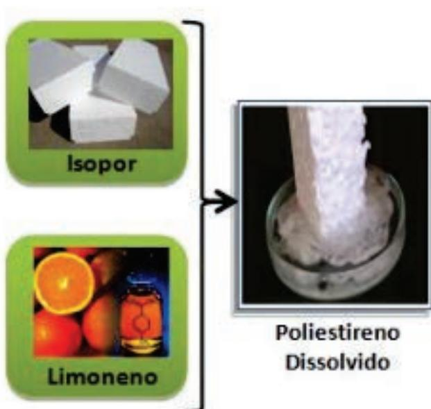
Representação dos materiais utilizados e do processo de dissolução do poliestireno presente no isopor
