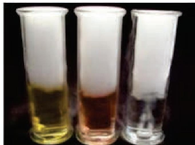
Aspecto da solução diluída de  $\text{NaOH}$  1 molar após a adição de indicadores ácido-base e gelo seco
