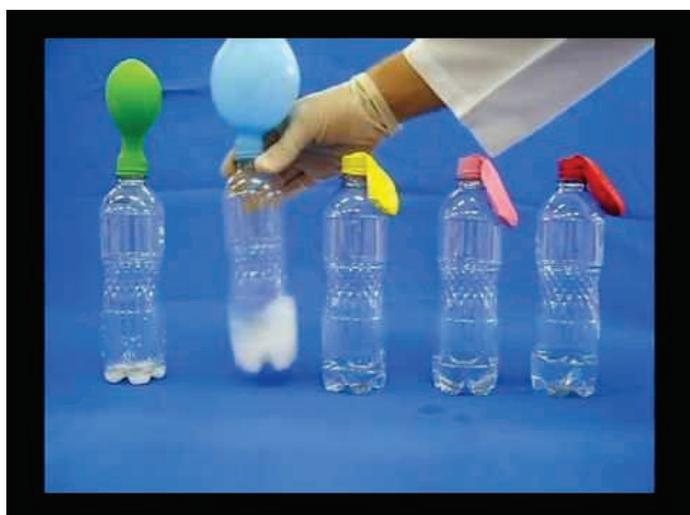
Representação do procedimento de formação de  $\text{CO}_2$  proveniente da reação entre o ácido acético presente no vinagre e o bicarbonato de sódio
