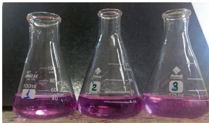
**Figura 1** - Solução de NaOH ( $0,101 \text{ mol L}^{-1}$ ) padronizada com  $\text{C}_8\text{H}_5\text{KO}_4$  ( $0,100 \text{ mol L}^{-1}$ ) realizada em triplicata.
