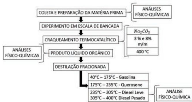
Figura 4: Fluxograma do processo de craqueamento e destilação fracionada
