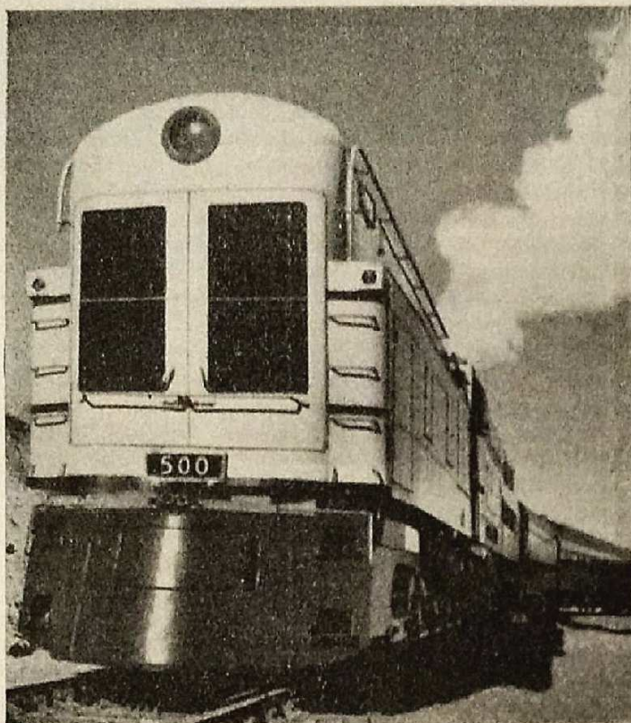
Uma das três locomotivas elétricas de alta velocidade de turbina a vapor, em serviço nos trens de passageiros da Estrada de Ferro Chesapeak & Ohio
