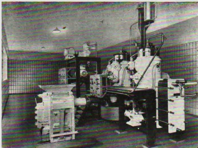
Instalação «Centriflow» para extração de gordura animal. Capacidade: 1500 — 2000 kg. de matéria prima por hora
