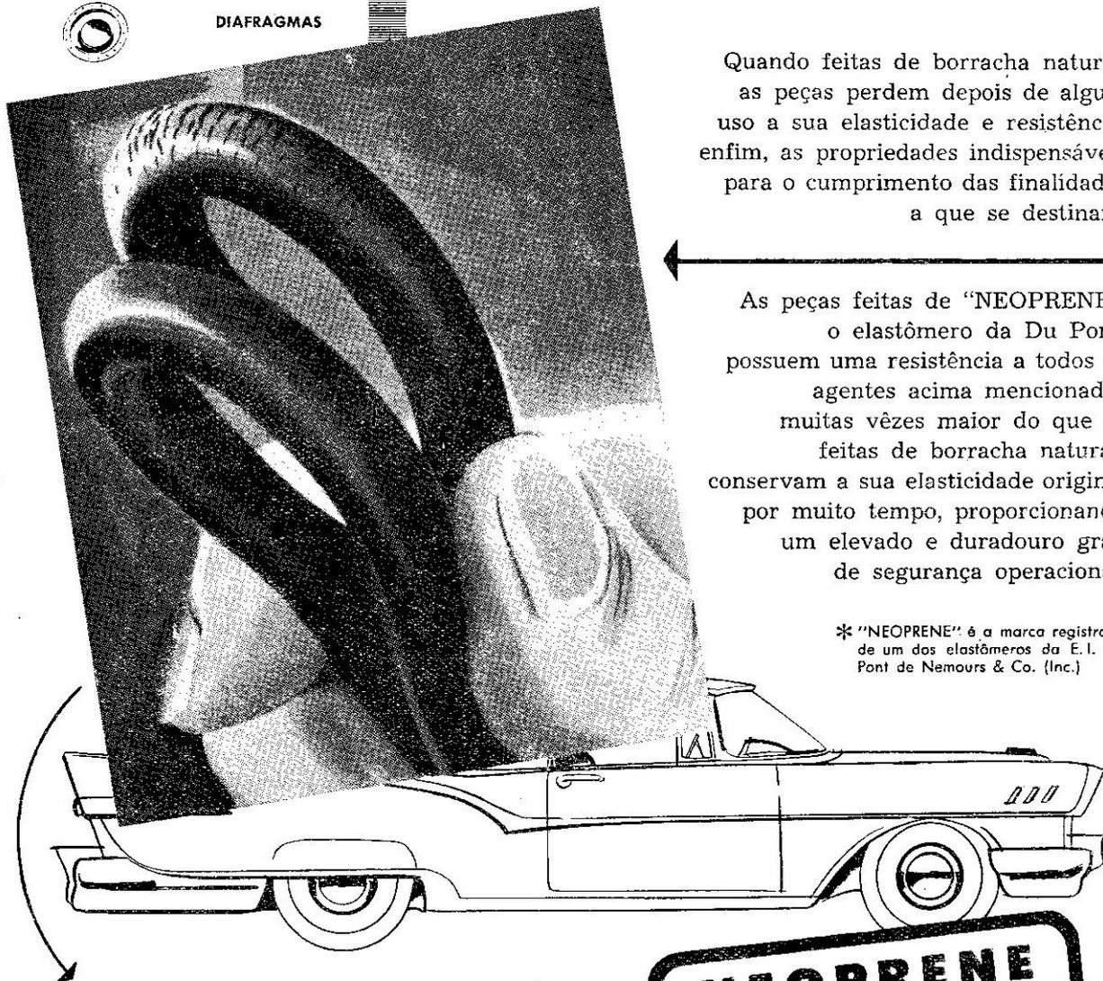
Estas duas tubulações de limpador de pára-brisa foram sujeitadas a um teste acelerado de resistência ao tempo. Depois de 72 horas na câmara de teste, o resultado é o que se vê: o tubo de cima, de borracha natural, tornou-se quebradiço, ao passo que o tubo de baixo, de "NEOPRENE", está em condições perfeitas de conservação.
