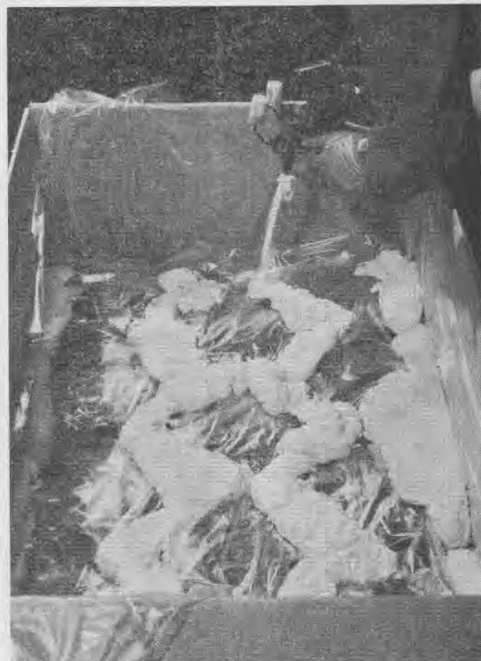
Lançamento da resina sintética por pistola de modo a constituir espuma na forma como se deseja. A espuma, enchendo os espaços vazios, dá uma proteção total ao objeto acondicionado.
