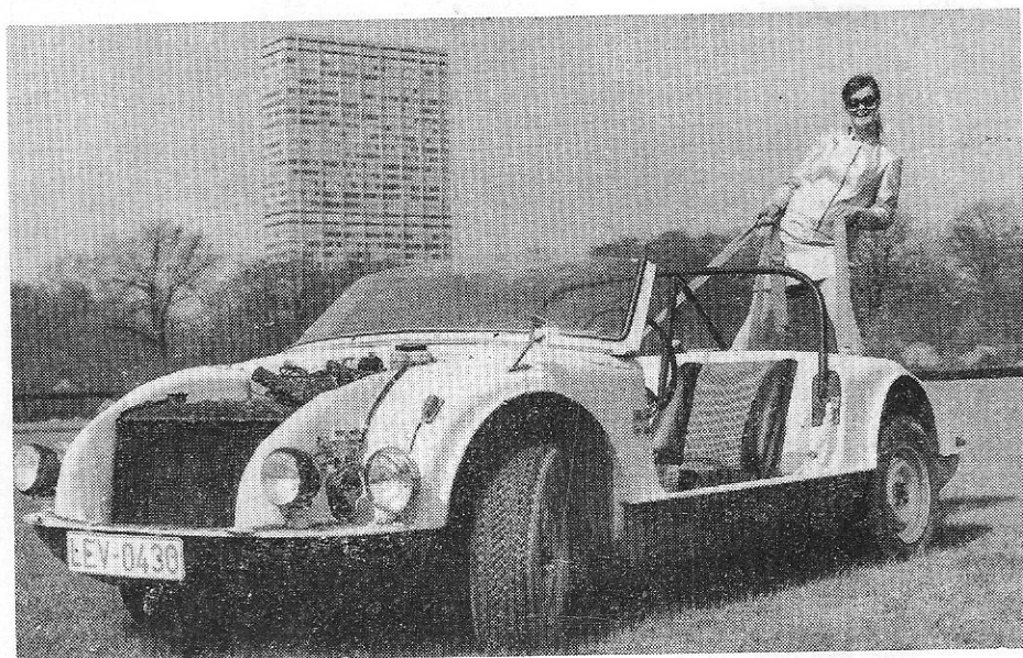
Este é o carro revolucionário, com chassis e carrosserie de plástico. Foto: Farbenfabriken Bayer A. G.
