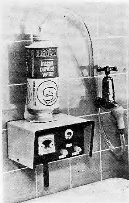
O aparelho completo ligado ao encanamento d'água de abastecimento
