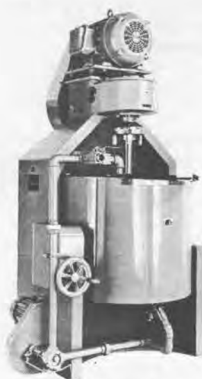
Moinhos "Attritor" para processamento de suspensões de amido e massas para papéis copiativos "sem carbono"
