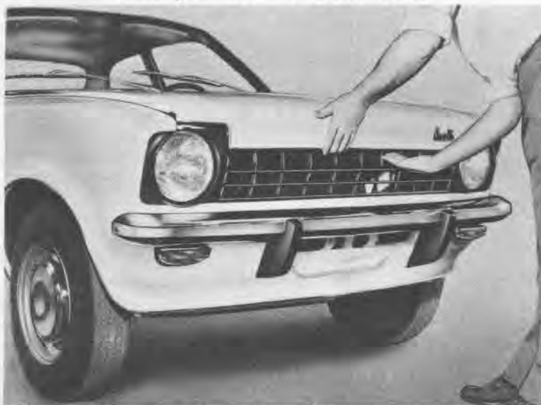
A grande dianteira e a moldura dos faróis do Chevette, novo carro da General Motors do Brasil, são feitas de resina sintética preta, moderno material plástico.
