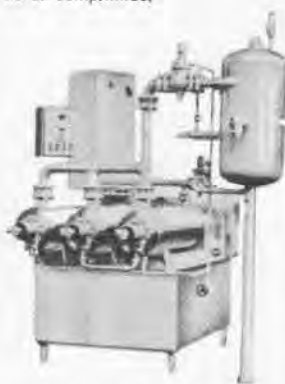
Trocadores de calor de superfície raspada "Votator" Para processamento de materiais viscosos, Fabricação de margarina, esfriamento de sucos, esterilização de produtos alimentícios, têmpera de chocolate, processamento de pastas de amido.
