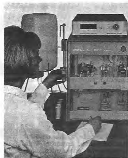
O Milko-Tester MK-III , aparelho para determinação de gordura no leite.
