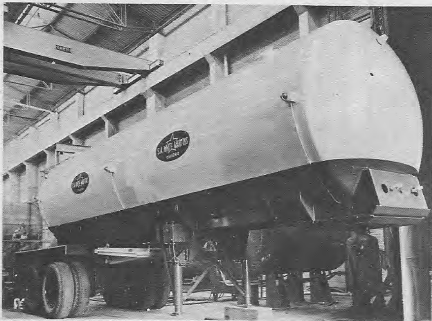
Tanque criogênico para transporte de Oxigênio, Nitrogênio e Argônio na forma líquida, fabricados pela White Martins.
