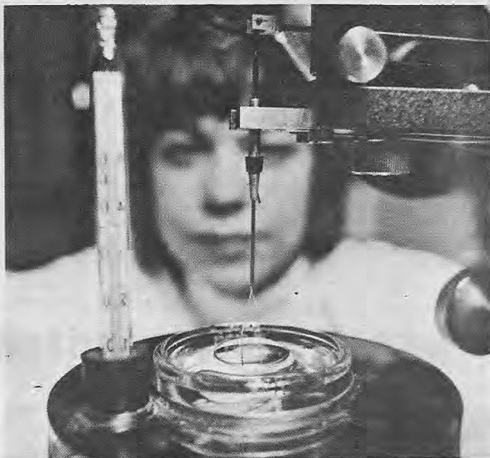
Medindo a tensão superficial de um líquido num dos laboratórios da Berol.
