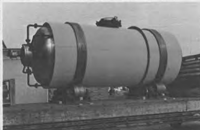
Homogeneizador para líquidos viscosos, capac. 8000 lts.
