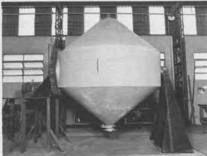
Homogeneizador para pós, capac. 10.500 lts.
