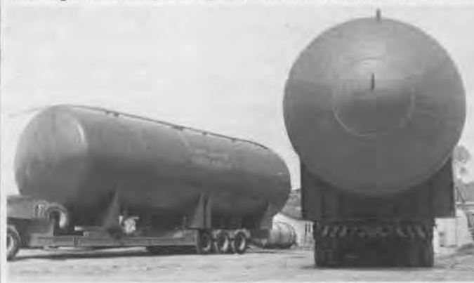
Desgaseificador, capac. 150.000 lts.
