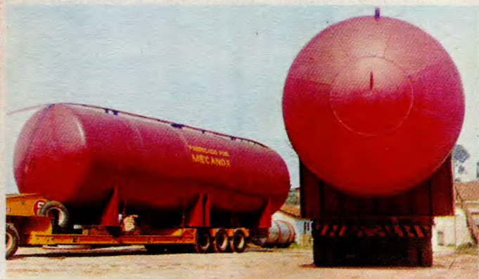
Desgaseificador, capac. 150.000 lts.
