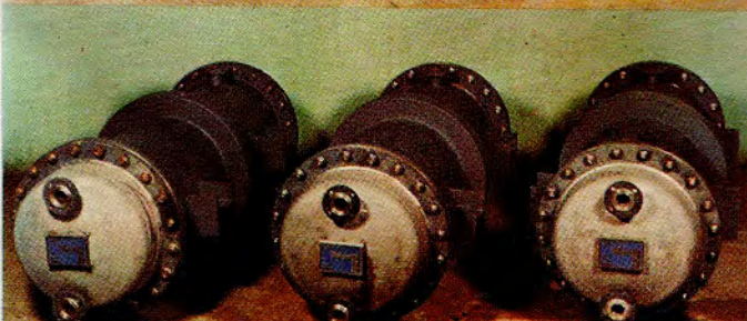
Condensador para hidrocarbonos, área 20 m 2 , 6/6 atm.
