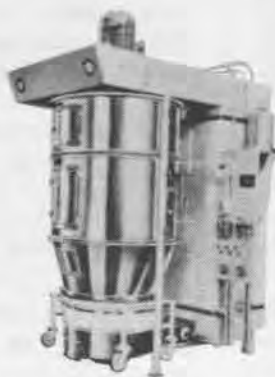
Secadores de leite fluidizado para massa de pastilhas
