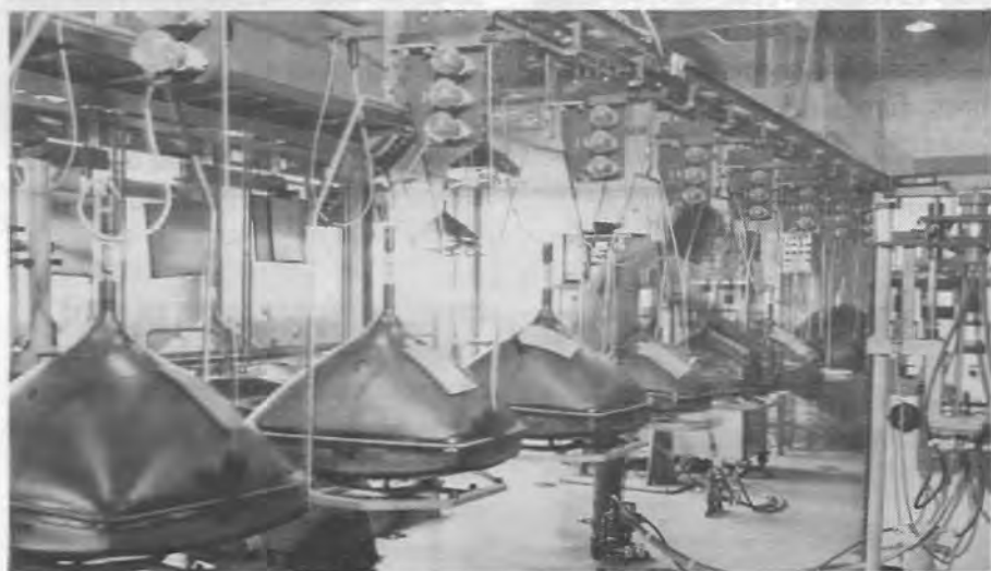
Cinescópios a cores em fase de acabamento, na fábrica em São José dos Campos.
