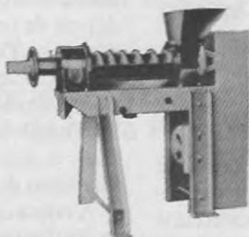
Despolpadeiras Despolpadeiras para frutas, tipo rosca e tipo palheta.
