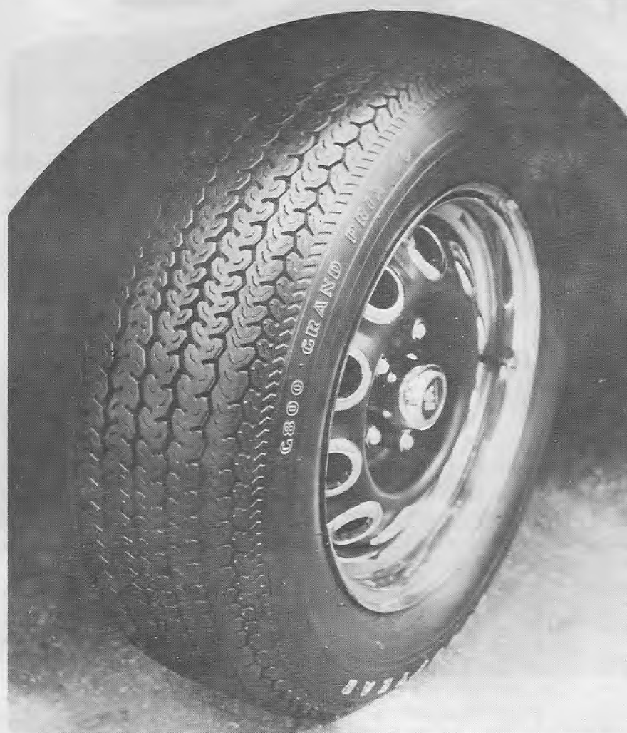
O PNEU G800 GRAN PRIX — Este é o pneu, com banda de rodagem mais larga, de quatro raios e cinco sulcos.
