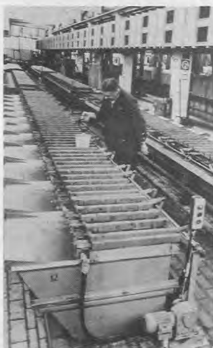
Vista parcial do departamento de eletrólise de prata no complexo metalúrgico da Degussa, o maior estabelecimento de refinação de metais preciosos no continente europeu. Aí se recupera prata fina de águas residuais fotoquímicas que encerram prata.
