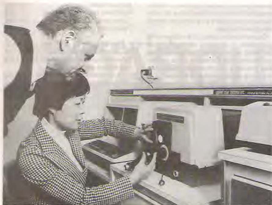
O espectrofotômetro da firma americana Applied Color Systems, Inc. tem a função básica de medir e registrar dados espectrais para comparação com dados previamente obtidos e/ou comparação com padrões de cores já estabelecidos.
