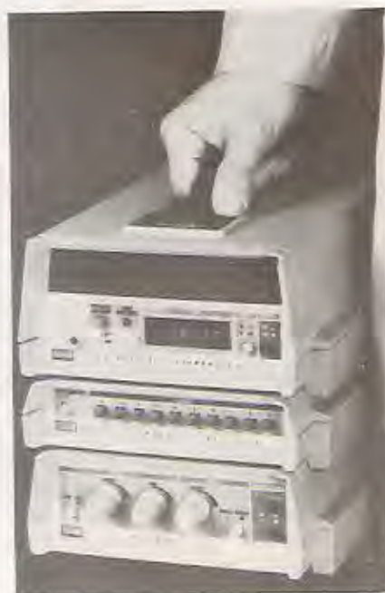
O Termômetro Digital 2190 A, fabricado pela Fluke, é o módulo comando para sistemas termoeletrônicos. Os módulos apresentados possuem encaixes que tornam o conjunto portátil.
