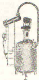
Reator para resinas.
