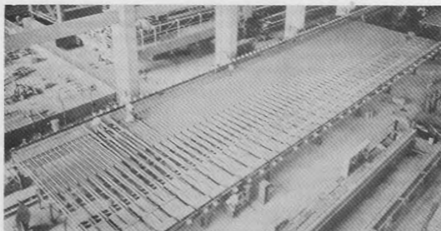
Leito de resfriamento pré-montado na fábrica da TORQUE.
