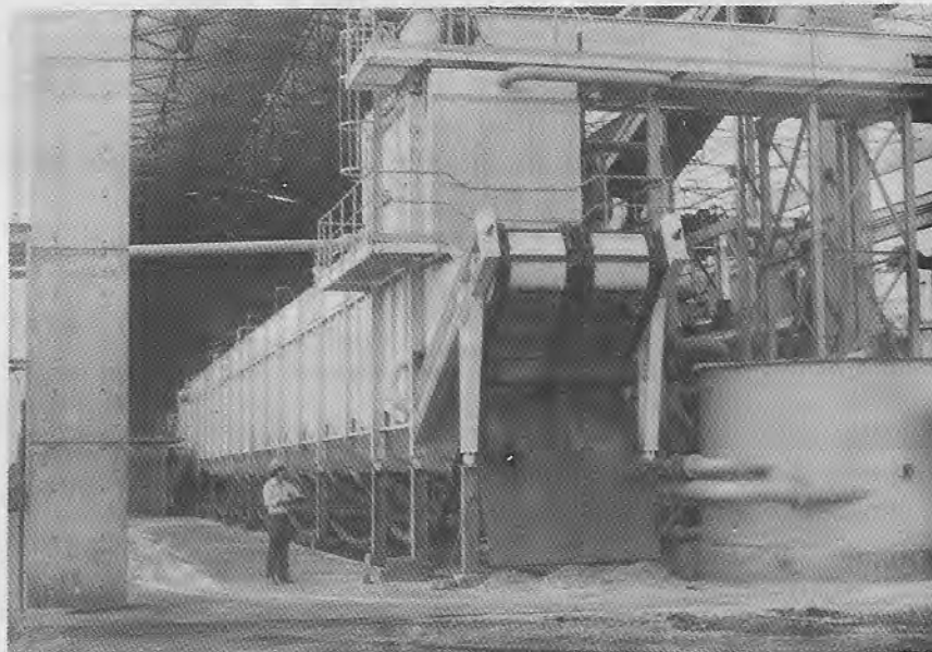
Difusor para extração de caldo de cana, instalado na Destilaria da Cooperativa Agropecuária Mourãoense, no Paraná.
