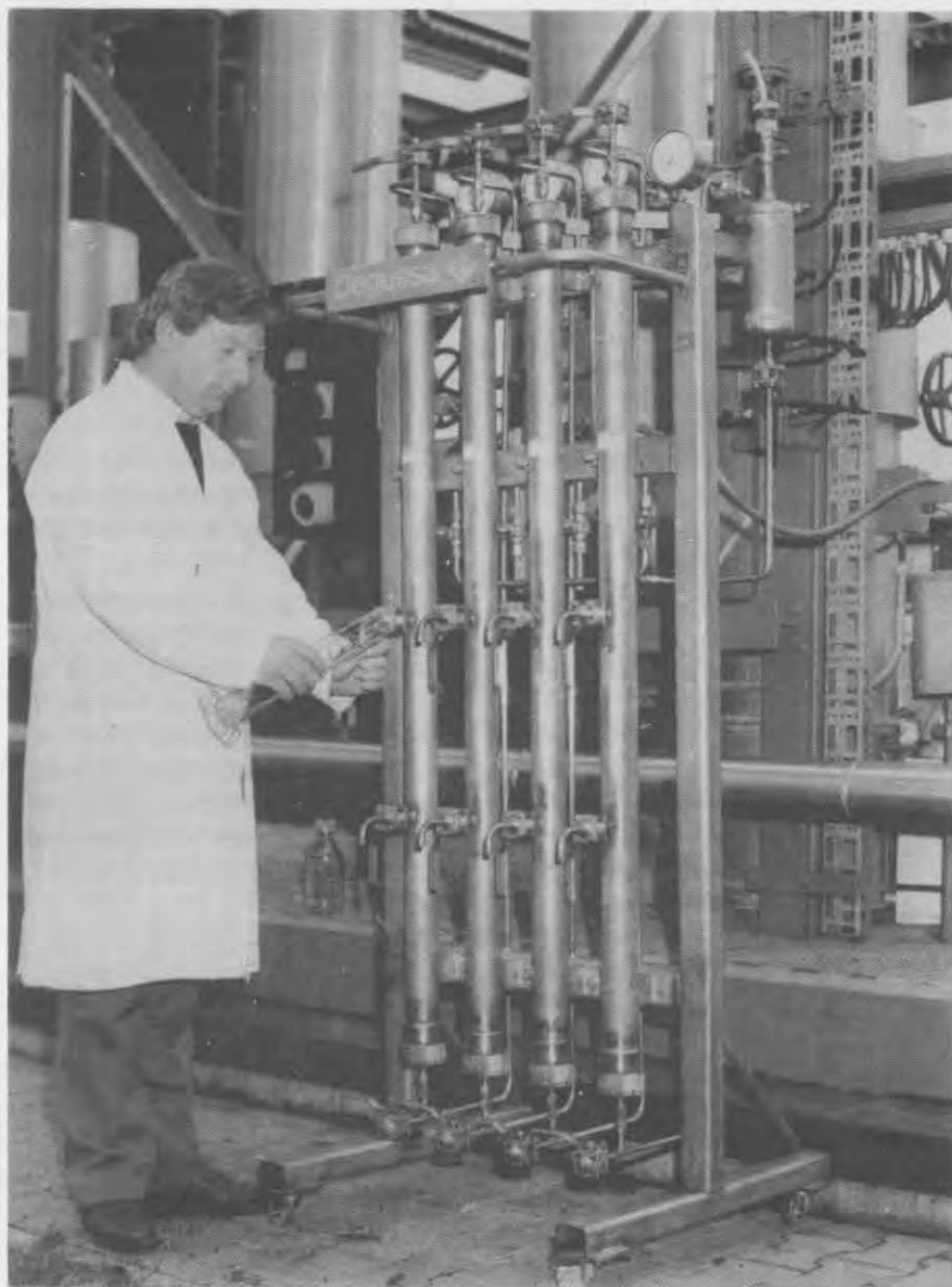
Nova instalação para ensaio de carvões ativados em funcionamento. A aparelhagem é de aço inoxidável com as dimensões de 100x65 cm e com o peso de 120 kg. A instalação é fácil.
