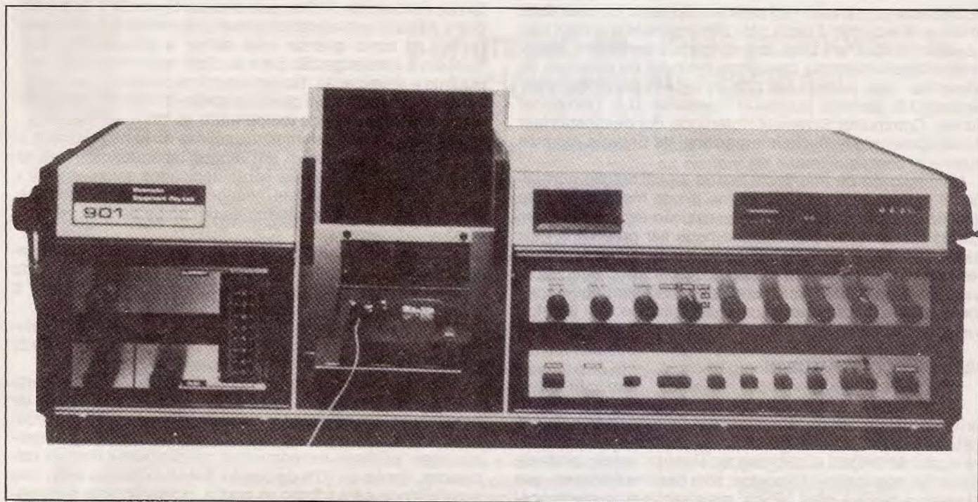
Figura 12 - Modelo de espectrômetro de absorção atômica. Monocromador de 3m, faixa 185-200nm. Forno de grafite. Leitura digital com interface para computador. Faixa de absorvância = 0,1 a 2,0.
