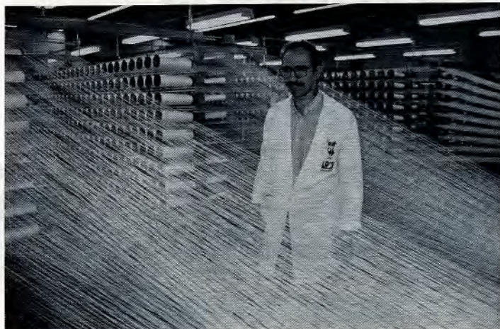
Unidade de monofilamento produz os fios de poliéster e poliamida
