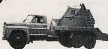
Poli-Guindaste com cap. de 12 tons. opera caçambas de 2,5 até 8,5 m 3 HOECHST - SUZANO
