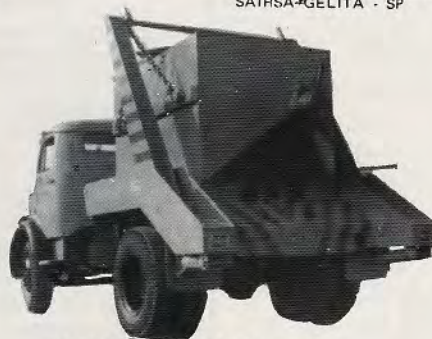
Mod. KPG -70/230 - SM - V3 - cap 8 tons. sapatas mecânicas pé de elefante com tanque prismático KTE 230/5000 RG-4 cap. 5000 lts - próprio para líquidos diversos - opera recipientes de 2,5 - 3,5 - 4,5 até 8,5 m 3 PETROBRAS - ref. landulfo alves - Bahia
