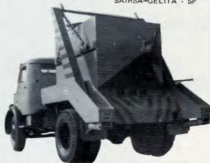
Mod. KPG - 70/230 - SM - V3 - cap 8 tons. sapatas mecânicas pé de elefante com tanque prismático KTE 230/5000 RG-4 cap. 5000 lts - próprio para líquidos diversos - opera recipientes de 2,5 - 3,5 - 4,5 até 8,5 m 3 PETROBRAS - ref. Iandulfo alves - Bahia
