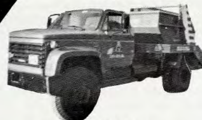
Poli-Guindaste - Cap. 6 tons. opera caçambas de 2,5 até 5m 3 SAIRSA-GELITA - SP
