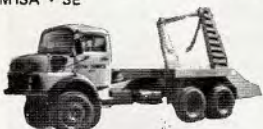
Poli-Guindaste - Cap. 14 tons. opera recipientes de 3,5 até 8,5m 3 DOW - Bahia
