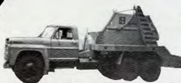
Poli-Guindaste com cap. de 12 tqts. - opera caçambas de 2,5 até 8,5 m 3 HOECHST - SUZANO
