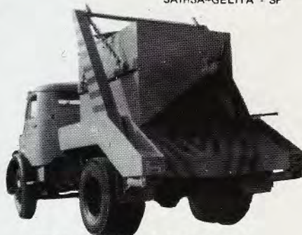
Mod. KPG - 70/230 - SM - V3 - cap 8 tons. sapatas mecanicas pé de elefante com tanque prismático KTE 230/5000 RG-4 cap. 5000 lts - proprio para líquidos diversos - opera recipientes de 2,5 - 3,5 - 4,5 até 8,5 m 3 PETROBRAS - ref. landulfo alves - Bahia
