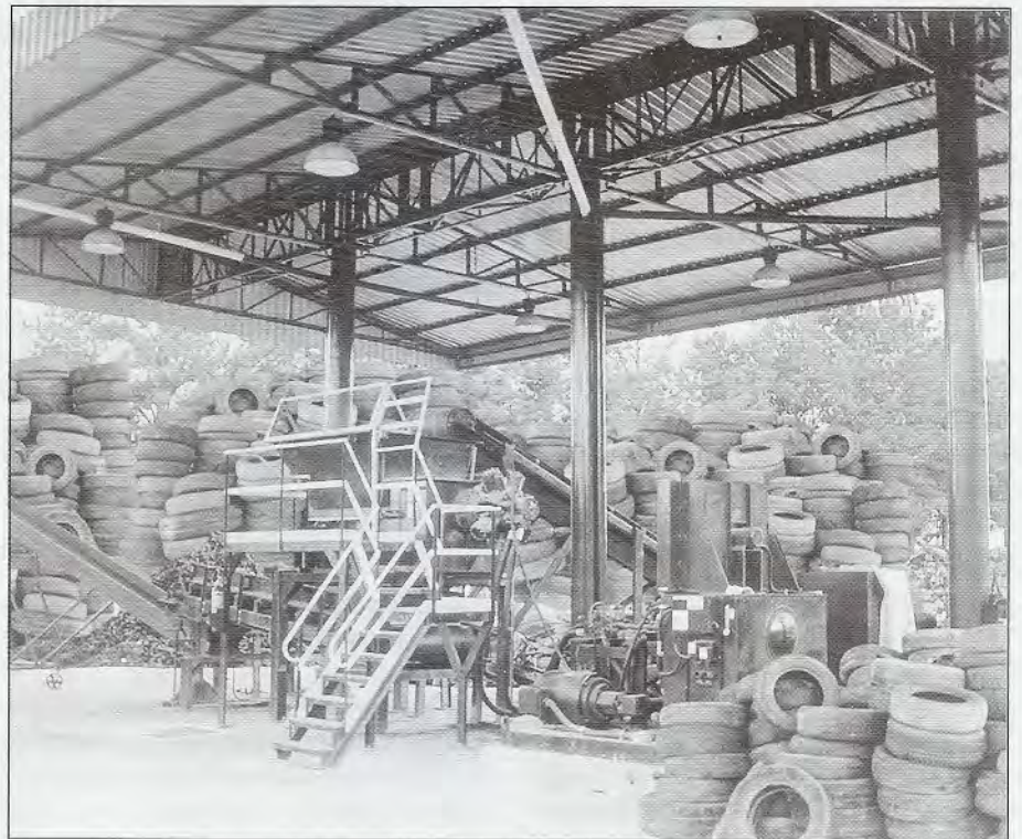
Área de armazenamento e trituração de pneus
