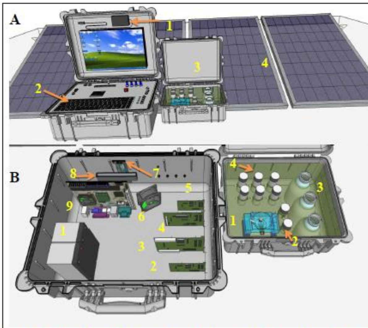
FIGURA 6.16. Figura descritiva do PG004 (A), com 1: GPS, 2: painel frontal, 3: módulo de fluxo, 4: placas solares. Detalhes internos do PG004 (B), com 1: baterias de 12 V com 1,3 A h -1 , 2: interface do módulo em fluxo, 3: placa do galvanostato, 4: placa do potenciostato, 5: placa microcontroladora de controle térmico, 6: cooler, 7: placa Wi-Fi® e Bluetooth®, 8: USB HUB, 9: CPU. Módulo em fluxo, com 1: EFC2, 2: V s , 3: compartimento das soluções, 4: \mu Ps.
