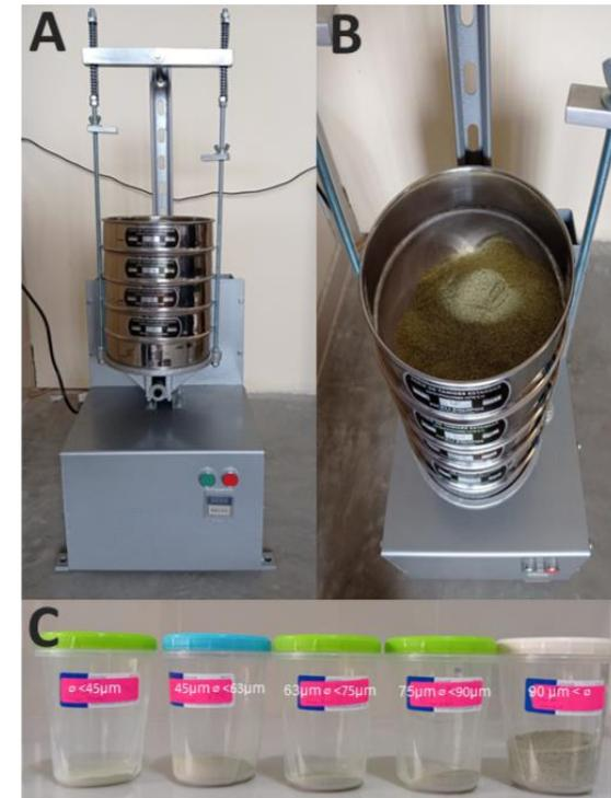
**Figura 3.** (A) y (B) Tamices superpuestos en el vibrador. (C) Clasificación por tamaños de las partículas de algas obtenidas luego del tamizado.
