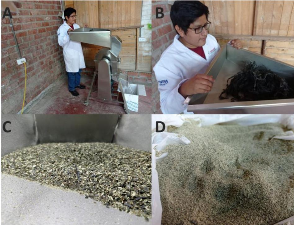
**Figura 2.** Reducción primaria del tamaño de las algas usando un molino de martillos.
