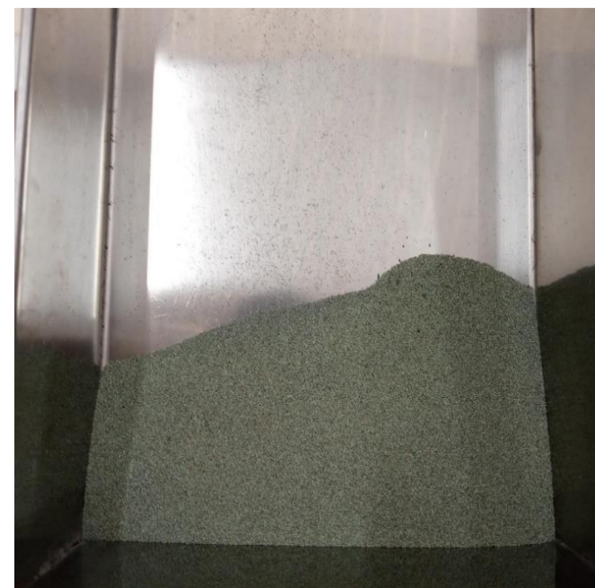
Figura 7: Transportador Sólido de Oxigênio utilizado no presente estudo em sua forma oxidada.
