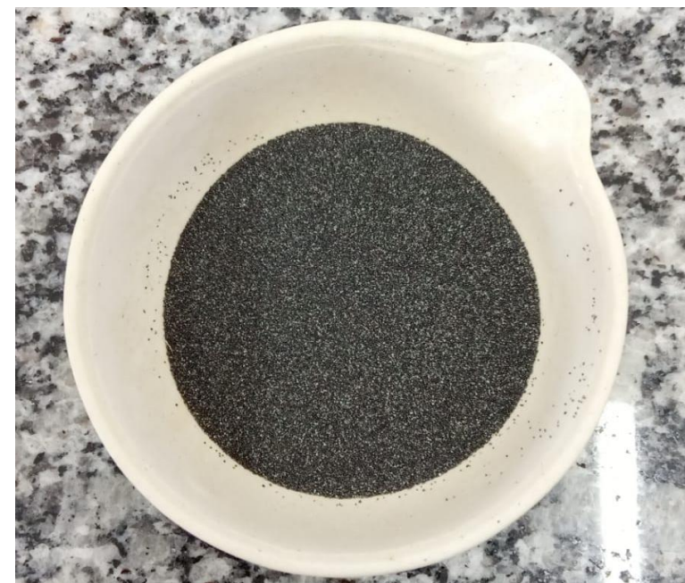
Figura 8: Transportador Sólido de Oxigênio, obtido em sua forma reduzida ao final do processo.
