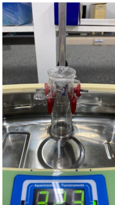
Figura 1. Dispositivo desenvolvido para detecção dos analitos de interesse via PhotometrixPRO
