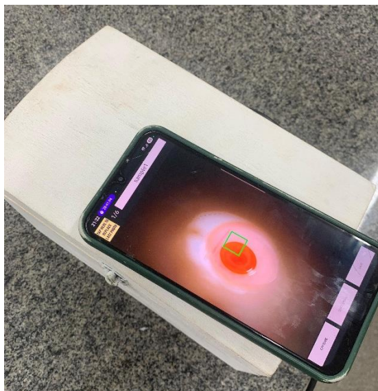
Figura 2. Caixa de MDF construída para detecção de \text{Fe}^{2+} via PhotometrixPRO.
