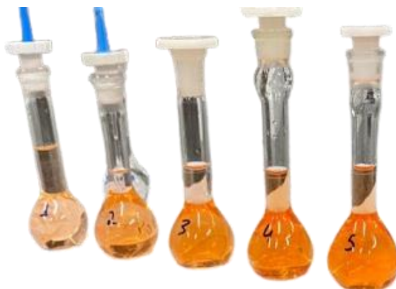
Figura 3. Padrões de Ferro (0 a 5 \text{mg L}^{-1} ), após a reação colorimétrica para obtenção da curva analítica do \text{Fe}^{2+} usando o PhotometrixPRO.
