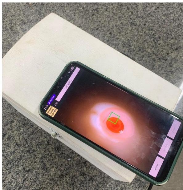
Figura 2. Caixa de MDF construída para detecção de cálcio via PhotometrixPRO.
