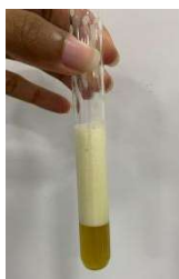
Figura 7: Tubo de ensaio após teste para identificação de saponinas.
