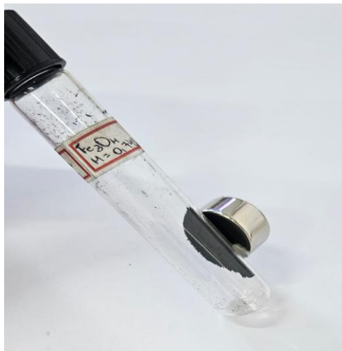
Figura 1: Nanopartículas de magnetita (NP- \text{Fe}_3\text{O}_4 ) sob efeito de ímã de neodímio
