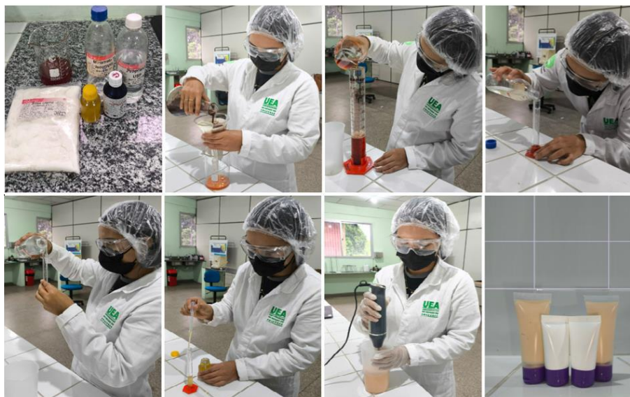
Figura 4- Processo de produção do creme hidratante facial
